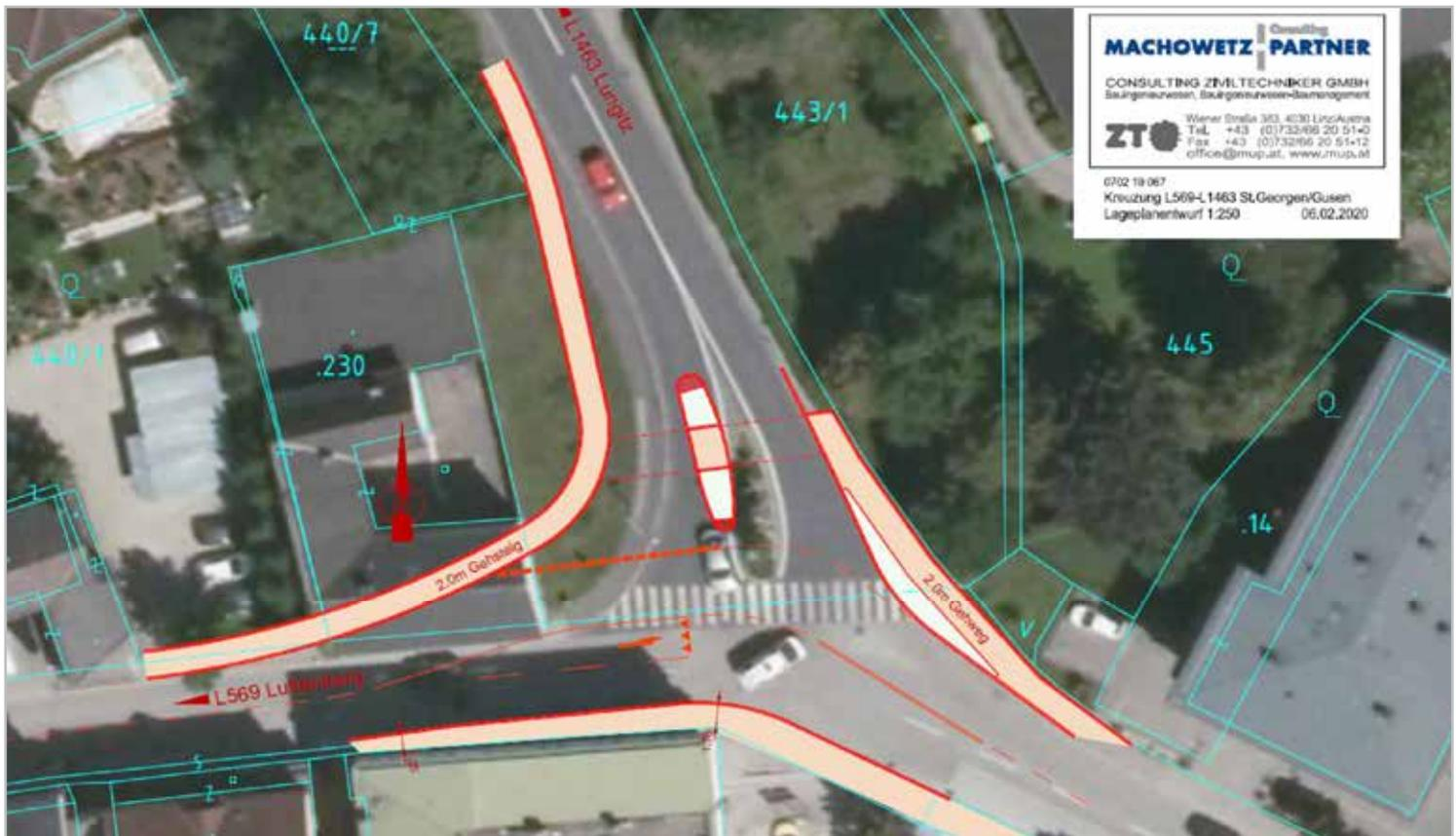
Entwurfsplanung der Neugestaltung der Sparkassenkreuzung. Derzeit wird auch noch intensiv an einer Variante mit Berücksichtigung eines kombinierten Geh- und Radweges gearbeitet. Dieser ist in der Plandarstellung nicht enthalten.
